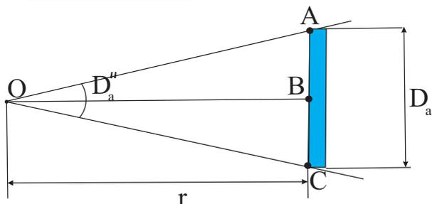
Рис. 3. К определению расстояния до автомобиля.
